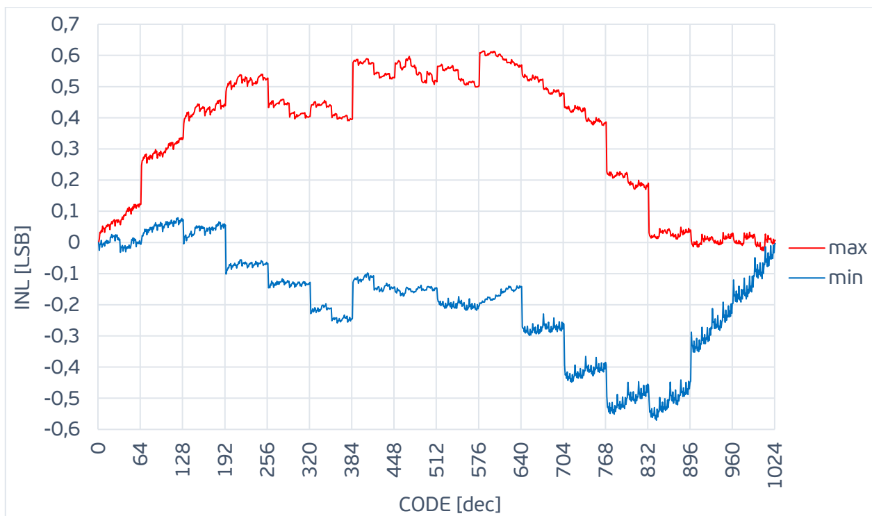
Рис. 5. Min/max INL от входного кода при высоких температурах ( v_{dda} = v_{ddd} = v_{refp} = 1.8 \text{ В} ; T = 125^\circ\text{C} )
